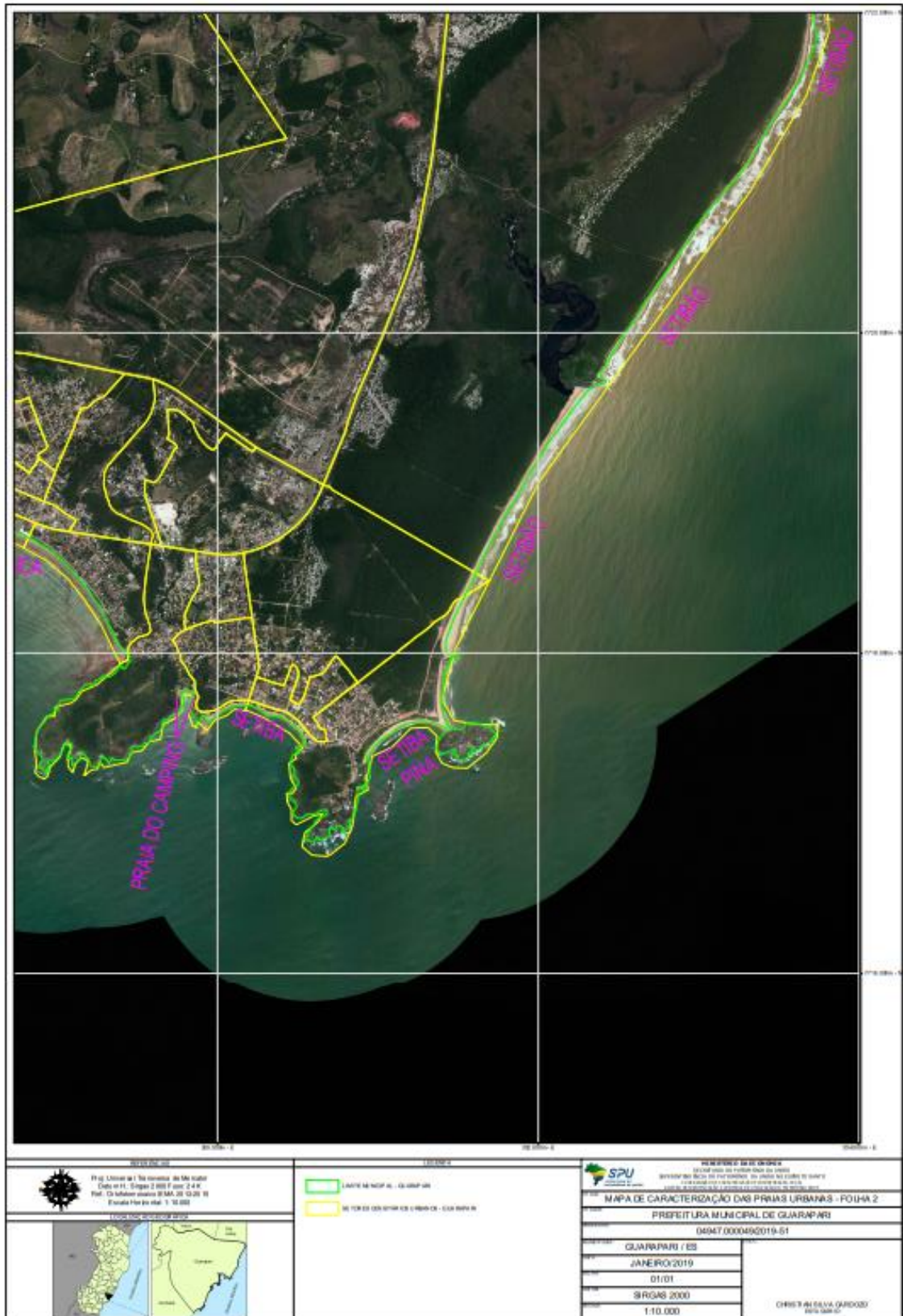
Figura 45: Terrenos de Marinha (LLTM) e seus acréscidos, assim como a Linha Preamar Média (LPM). Fonte: SPU-ES
